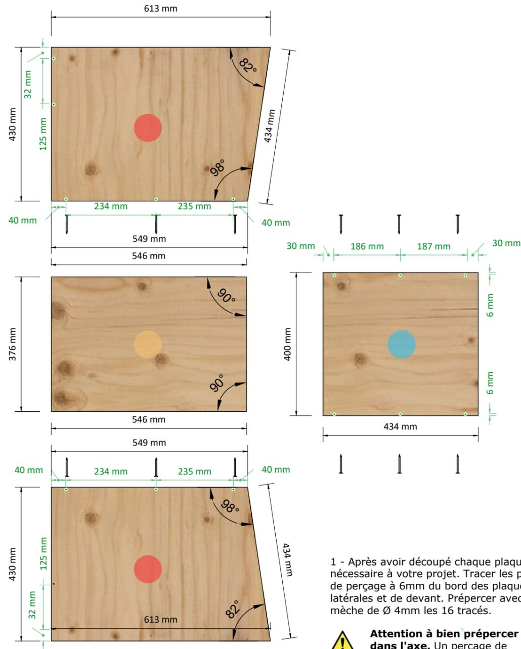
1 - Après avoir découpé chaque plaque nécessaire à votre projet. Tracer les points de perçage à 6mm du bord des plaques latérales et de devant. Prépercer avec une mèche de Ø 4mm les 16 tracés.
